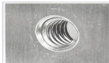
4. Saque las espigas de la parte insertada, y la rosca quedará permanentemente reparada.
