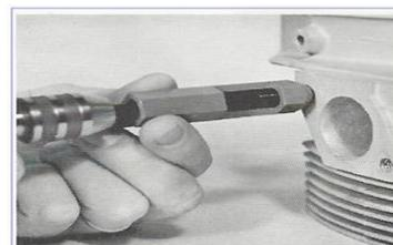
3. Instale la nueva pieza Perma-Coil para insertar
